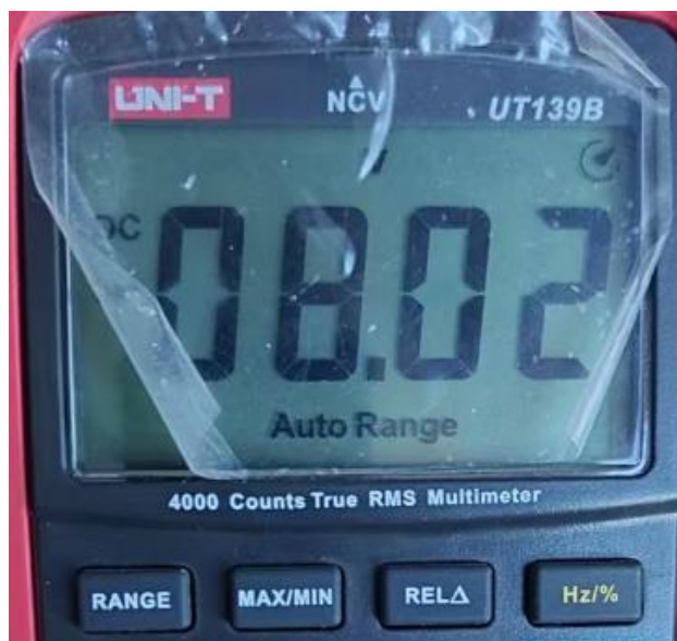
图 4.4.15 万用表测量 AI1 端口电压
