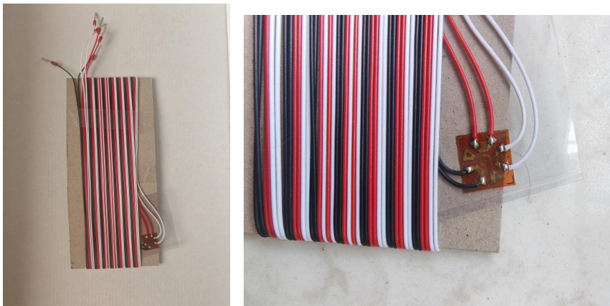
图 5 应变花引线接线工艺示例
