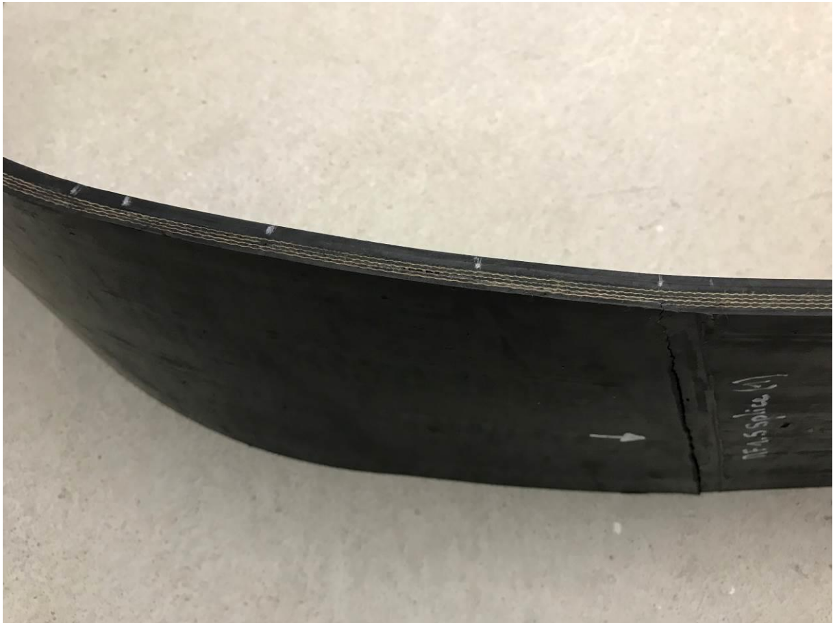
用 MF1.5 的第一个接头，约 1,284,000 次 (上部和底部)
