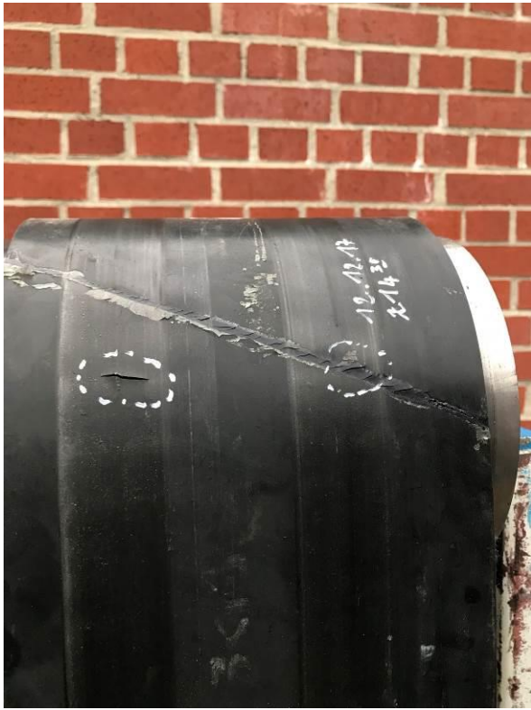
用 MF1.5 的第一个接头，约 900,000 次 (上部和底部)
