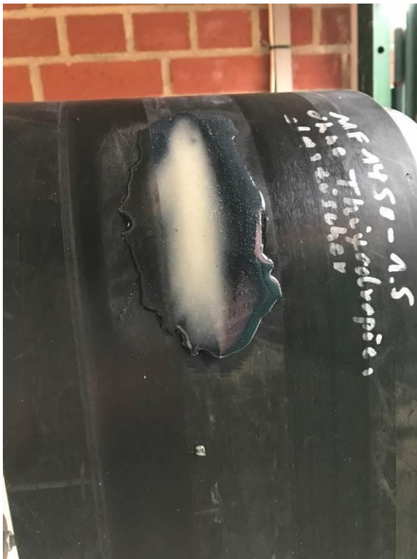
用 Multiface 1.5 (E1450 版本, 黑色) 非触变修复裂口(125,000 转)
