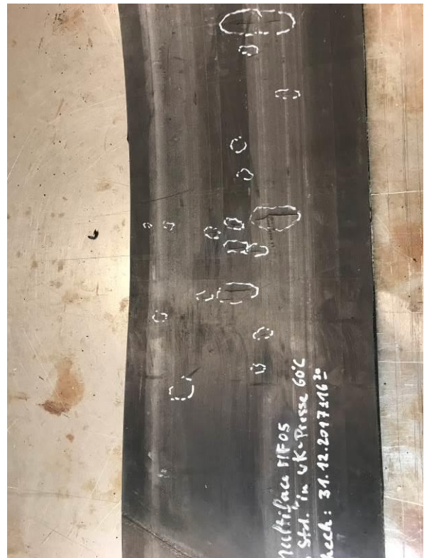
约 1,284,000 转后输送带盖胶上的裂纹(上面)
