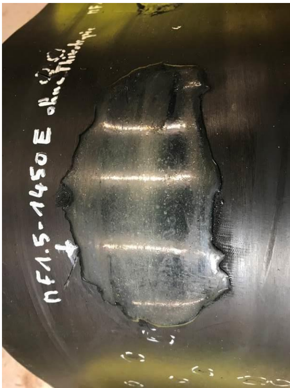
用 Multiface 1.5 (E1450 版本, 黑色) 非触变修复裂口(1,013,000 转), 上下部
