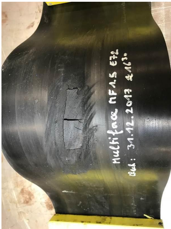
用 Multiface 1.5 (E72 版本, 黑色) 修复裂口(开始约 1,116,000 转),上部 and 下部
