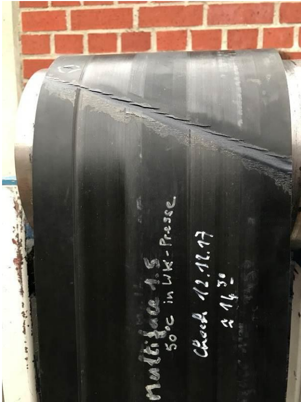
用 MF1.5 的第二个接头，约 900,000 次 (上部和底部)
