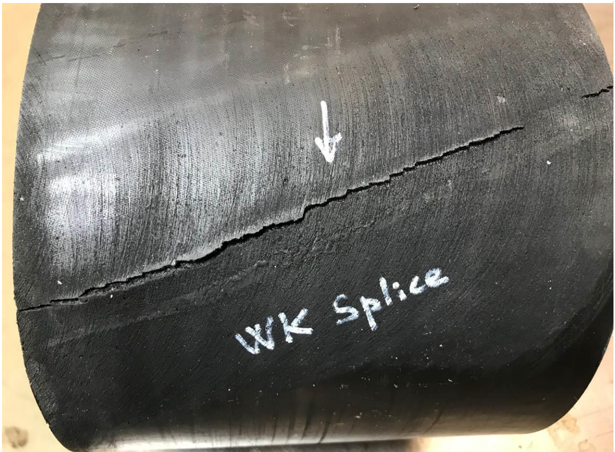
WK 热硫化接头，约 1,284,000 次 (上部和底部)
