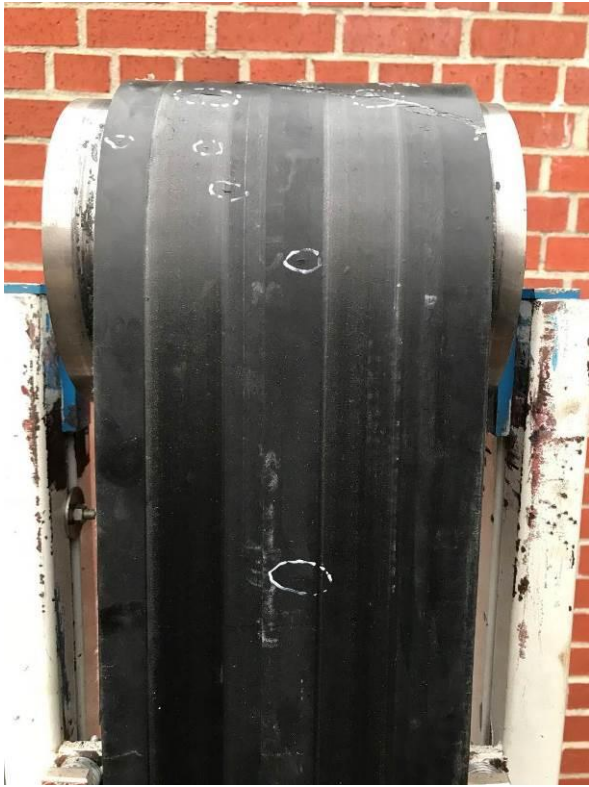
约 600,000 转后输送带盖胶上的裂纹(上面)
