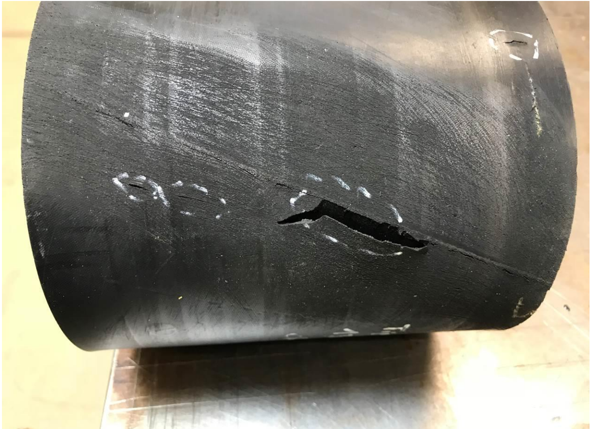
WK 热硫化接头，约 1,284,000 次 (上部和底部)
