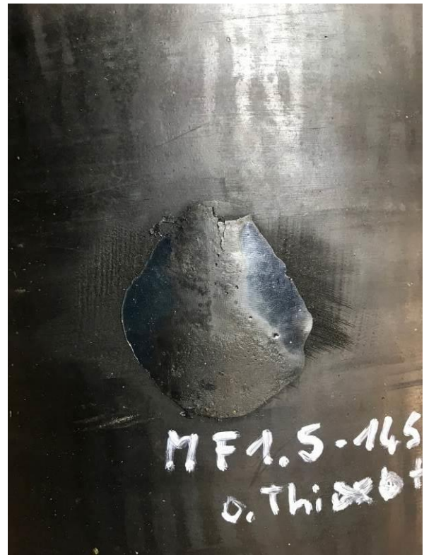
用 Multiface 1.5 (E1450 版本, 黑色) 非触变修复裂口(1,013,000 转), 上下部
