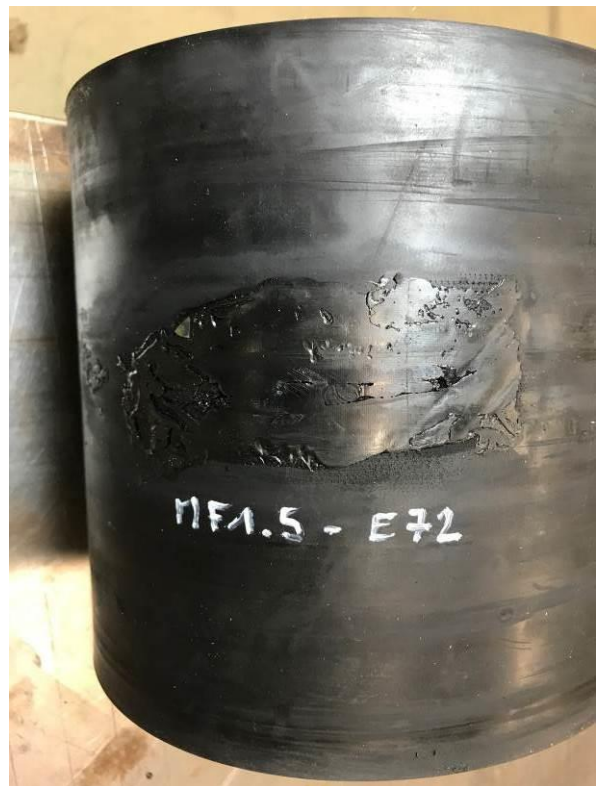
用 Multiface 1.5 (E72 版本, 黑色) 修复裂口(开始约 1,116,000 转),上部 and 下部
