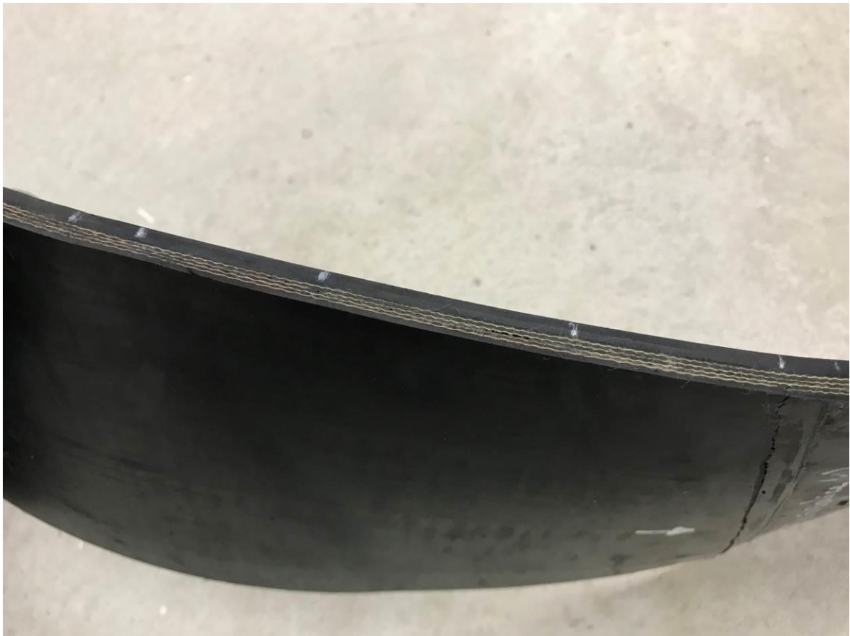
用 MF1.5 的第二个接头，约 1,284,000 次 (上部和底部)
