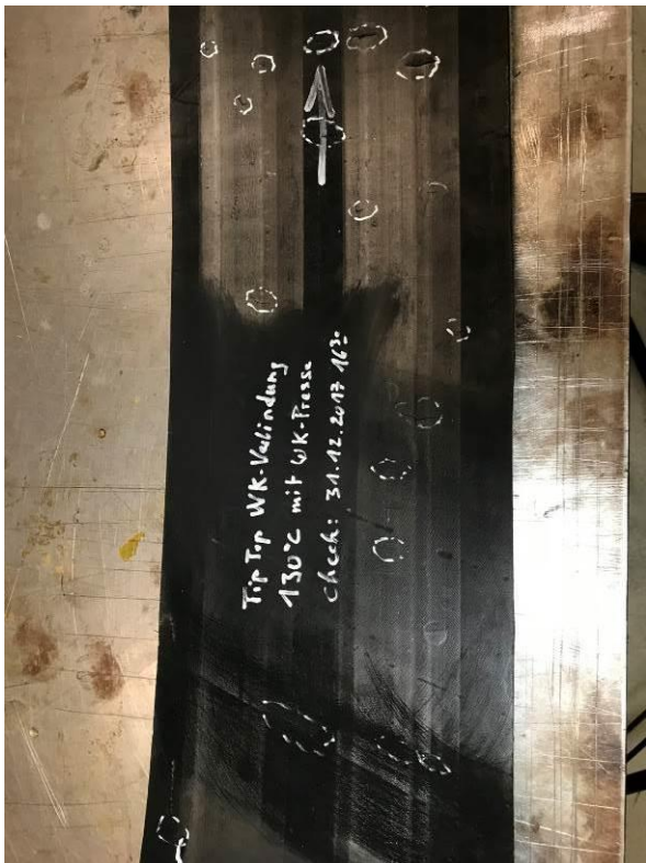
约 1,284,000 转后输送带盖胶上的裂纹(上面)
