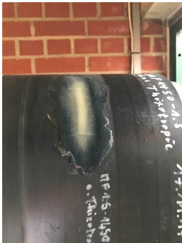
用 Multiface 1.5 (E1450 版本, 黑色) 非触变修复裂口(从开始起约 63,000 转)
