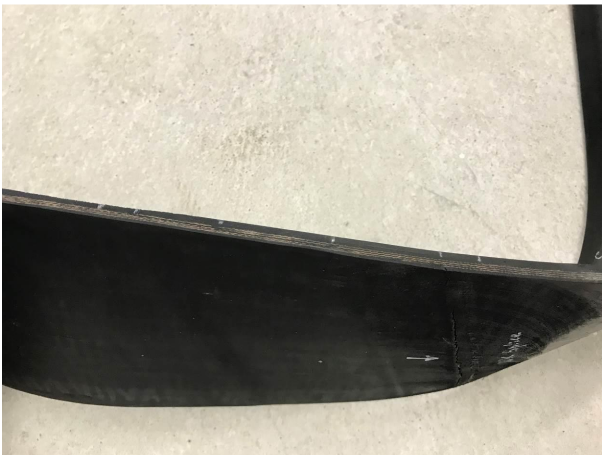
WK 热硫化接头，约 1,284,000 次 (上部和底部)
