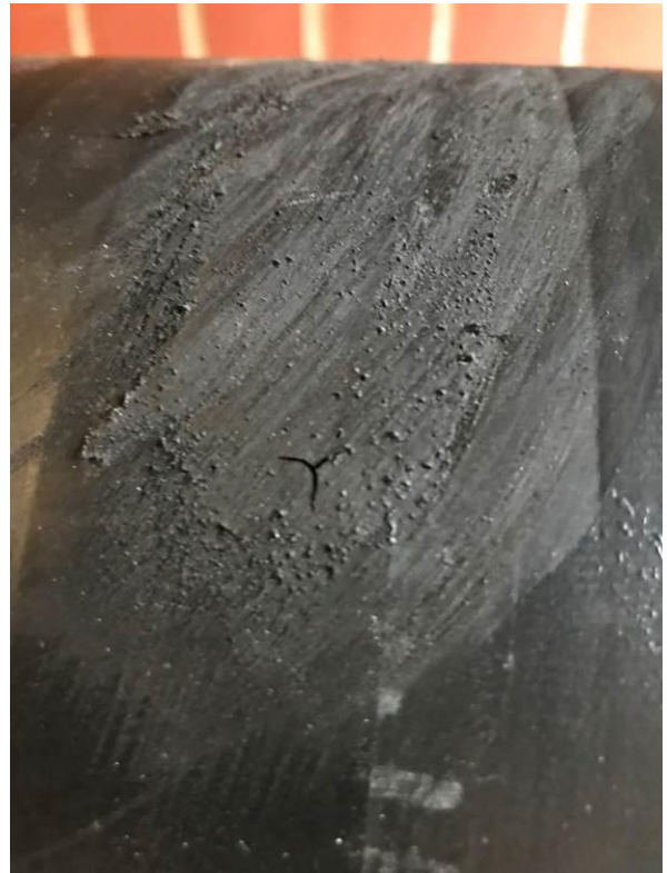
用 Multiface 1.5 (E72 版本, 黑色) 修复裂口(开始约 365,000 转)
