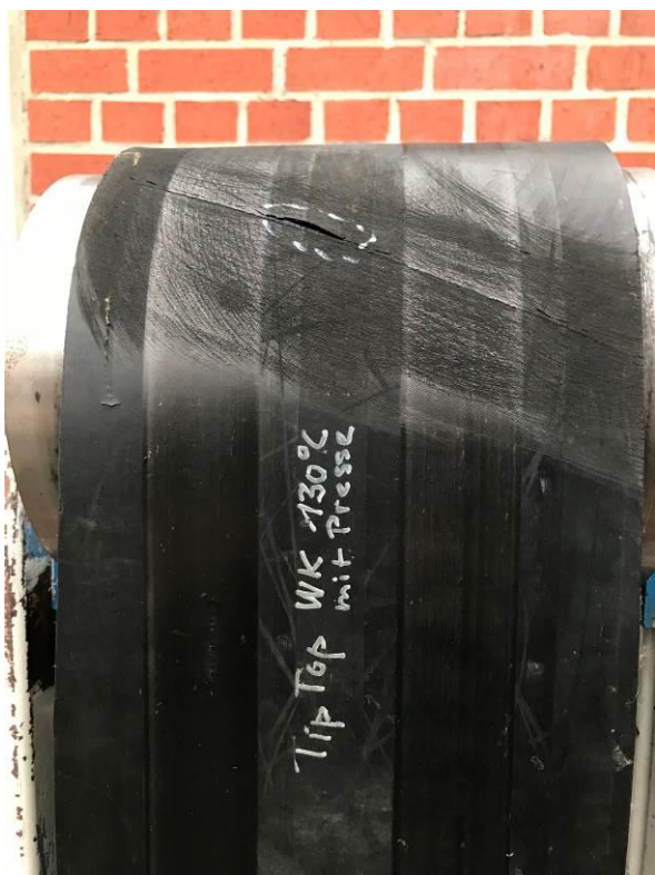
WK 热硫化接头，约 900,000 次 (上部和底部)
