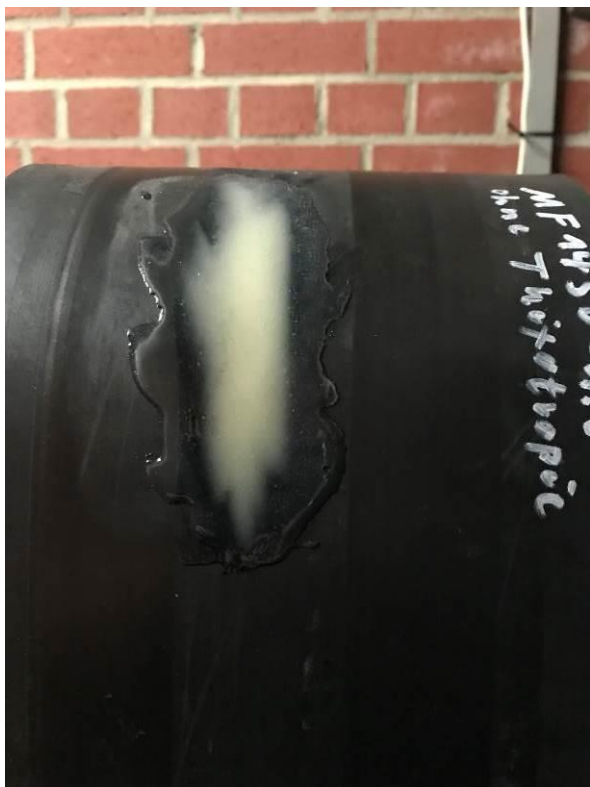
用 Multiface 1.5 (E1450 版本, 黑色) 非触变修复裂口(从开始起约 63,000 转)
