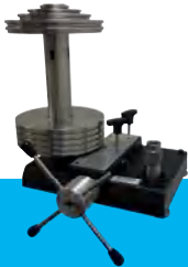
CPB3800HP 紧凑设计，高压型， 带双量程活塞-气缸系统
